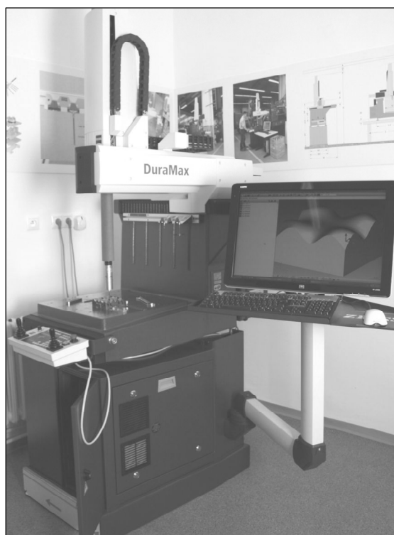
13. ábra: Duramax elnevezésű koordináta mérőrendszer [6]
